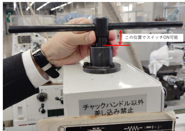
図6 主軸安全装置（チャックハンドルインターロック）の解除寸法
