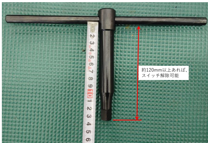
図6 主軸安全装置（チャックハンドルインターロック）の解除寸法
