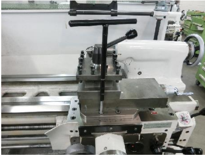
図 6 刃物台回転部用 T 型ロングレンチ (貸出可)
