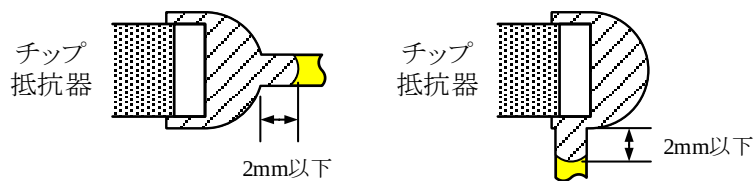
(c)はんだの拡散範囲 (はんだの流れ) 図 2 2 チップ抵抗器のはんだ付け基準
