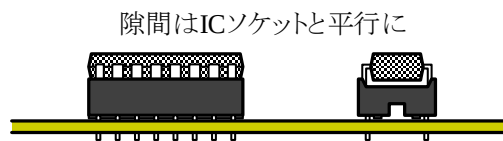
図 1 6 DIP IC 等の差し込み方
