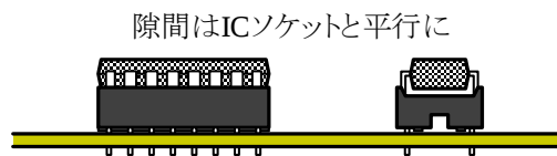
図 1 6 DIP IC 等の差し込み方
