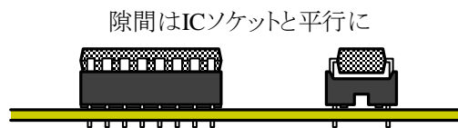
図 1 6 DIP IC 等の差し込み方
