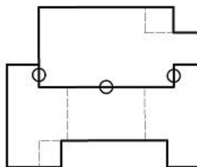
※ ○印部分は、部品①を反転させて、同じ箇所を測定する
