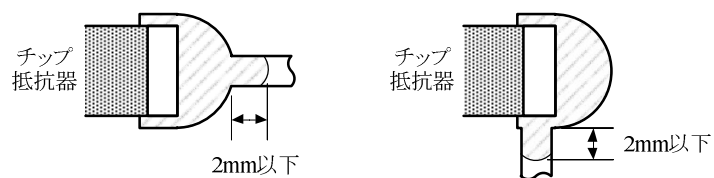
(c)はんだの拡散範囲 (はんだの流れ)
