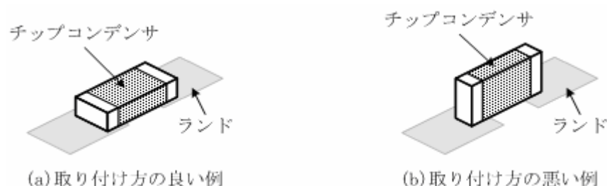
図 9 チップコンデンサの取付け方
