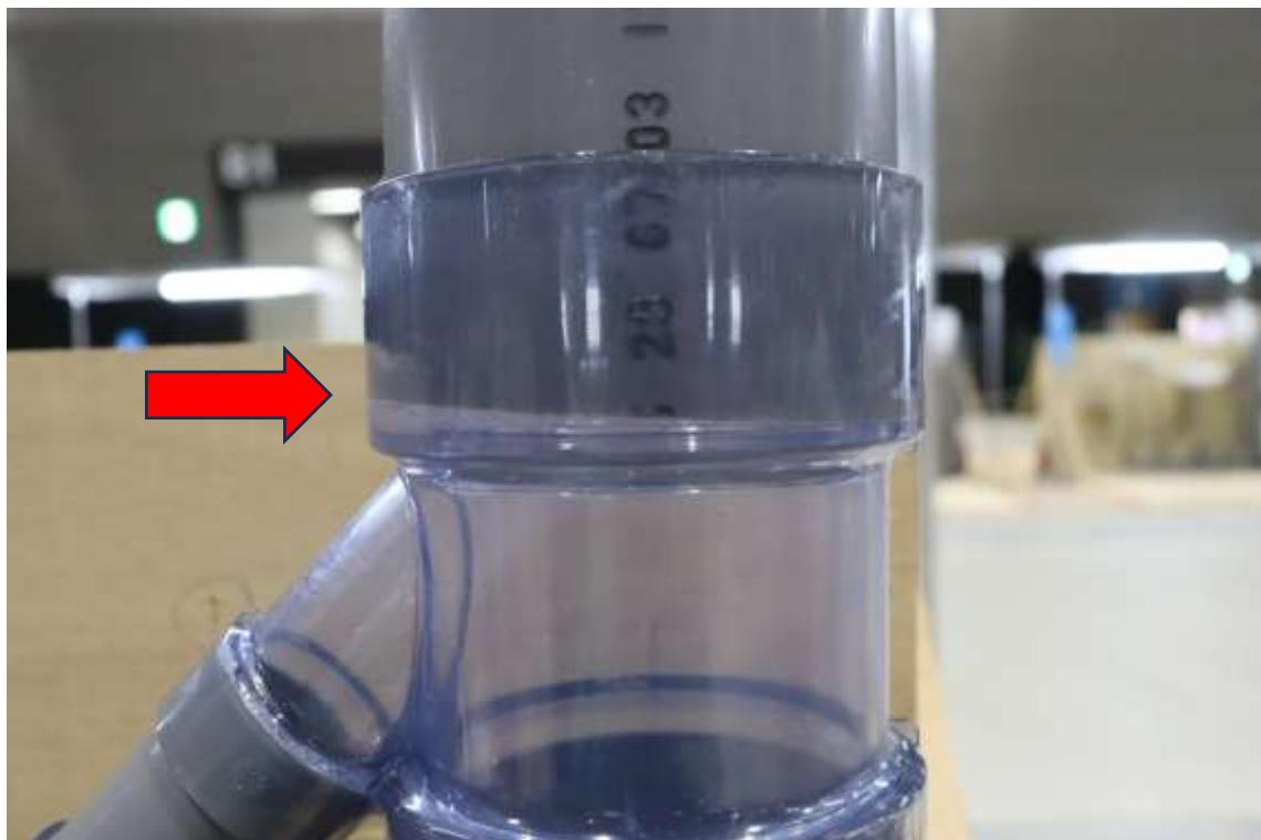
塩化ビニル管 減点事例：差し込み不良。
