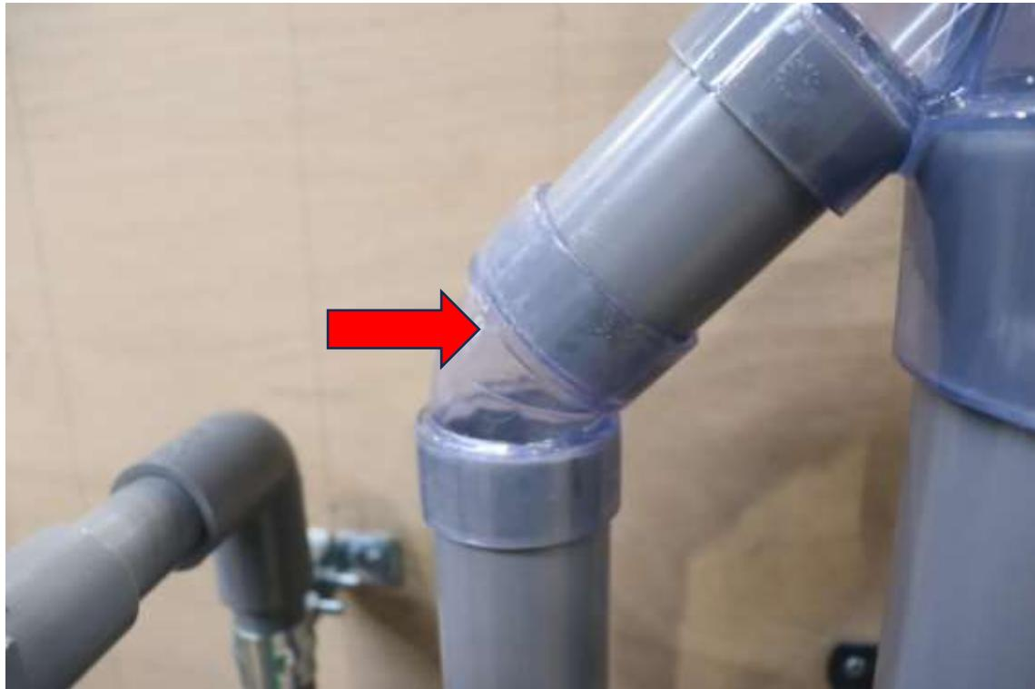
塩化ビニル管 減点事例：切断面が直角に切断されていない。
