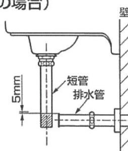
②印より5mm下の位置でパイプカッター・ノコギリなどで切断する。
