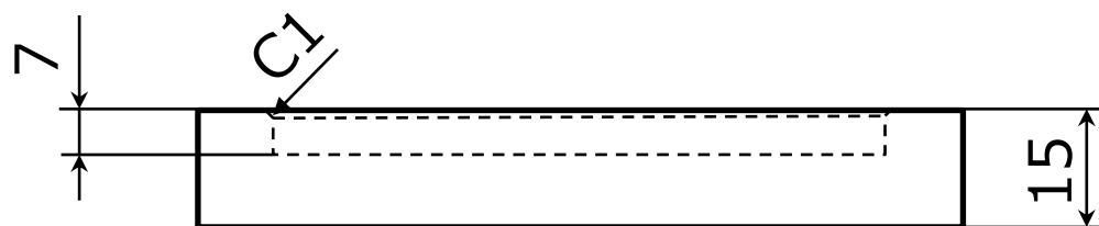
第63回 技能五輪全国大会 「フライス盤」 職種 測定検査工具図面
