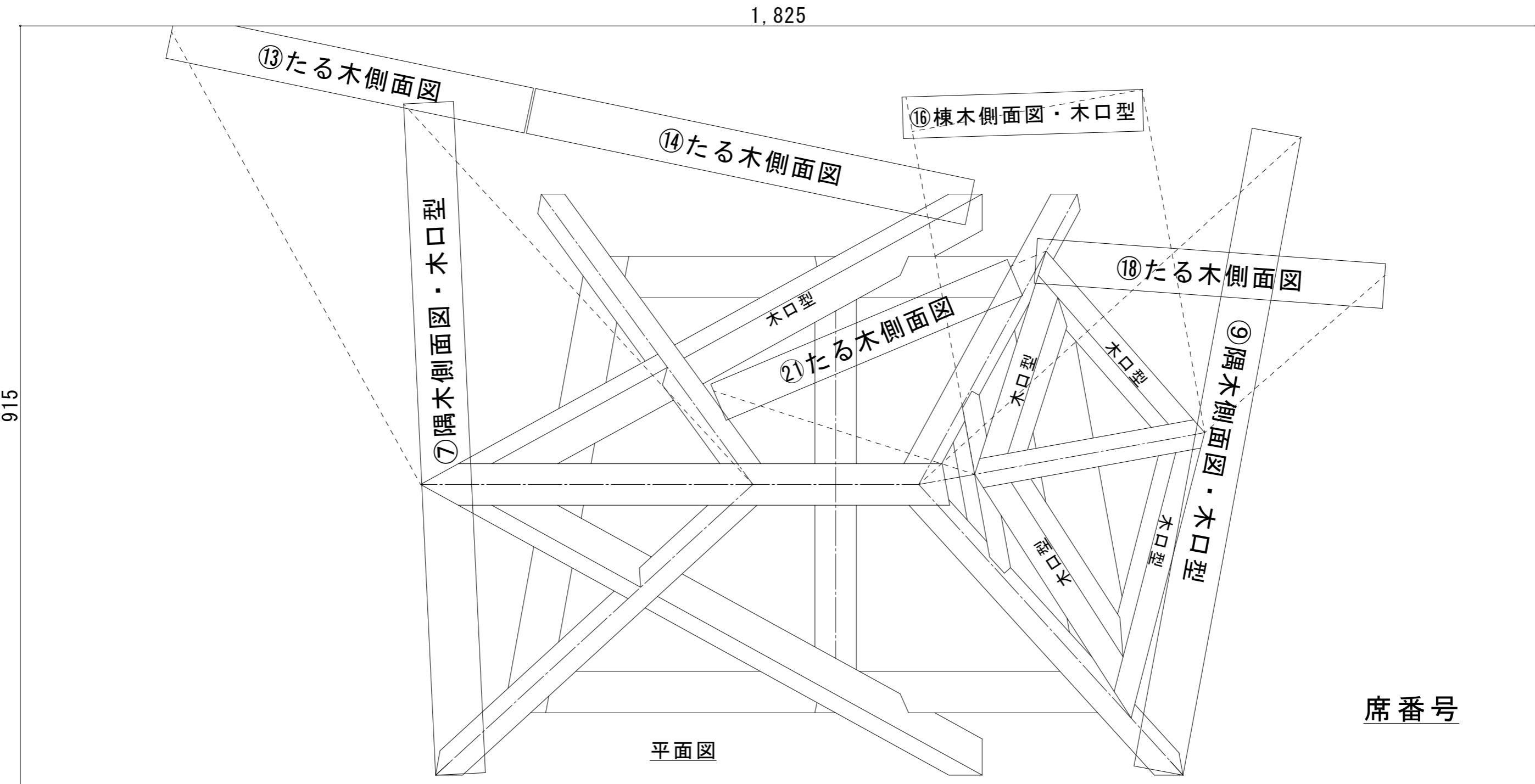
※側面図は平面図より直接立ち上げても、離して描いても良い
