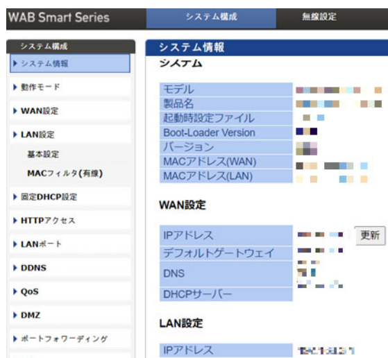
ファイル名「fig1」（拡張子省略） Fig.1 WAN側 LAN側 IP アドレスが確認できる画面（例）
