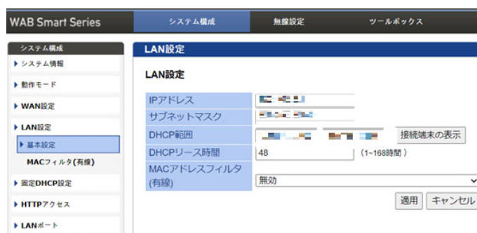
ファイル名「fig2」（拡張子省略） Fig.2 DHCP 範囲を確認できる画面（例）
