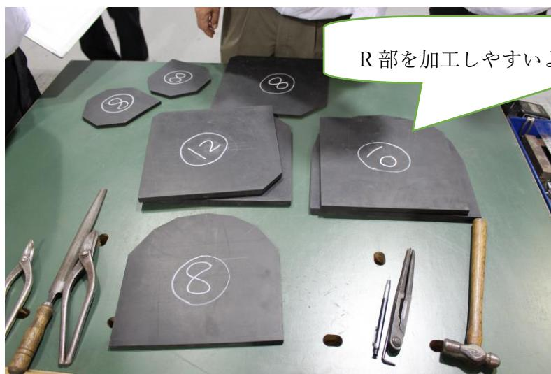
R 部を加工しやすいように事前に型板を加工している。
