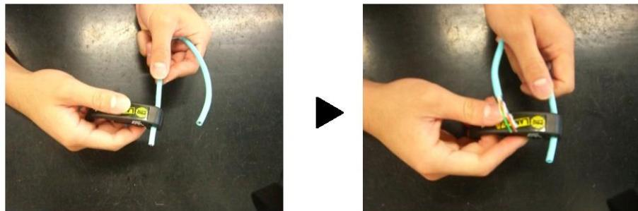
ケーブルを折り曲げ、片方の被覆を? いて、次に他方の被覆を剥く? OK
