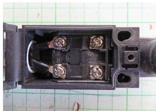
質問 11：リミットスイッチに至る配線において、PF 管の管端ブッシングとコードグリップとの間の隙間が大きいと減点になるのでしょうか。また、PF 管の S 曲げは必要でしょうか。
