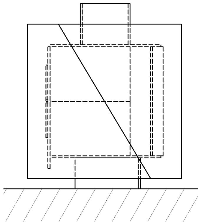
5. 溶接番号 ④以外の溶接については工作台上に材料符号 ④を置き、定められた溶接姿勢で行う。また、工作台と ④の間に支え物を入れてはいけない。
