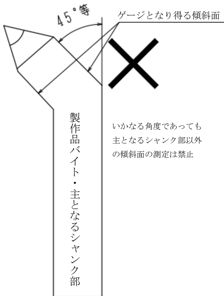
図10 課題テーパ角近似傾斜面の製作の禁止
