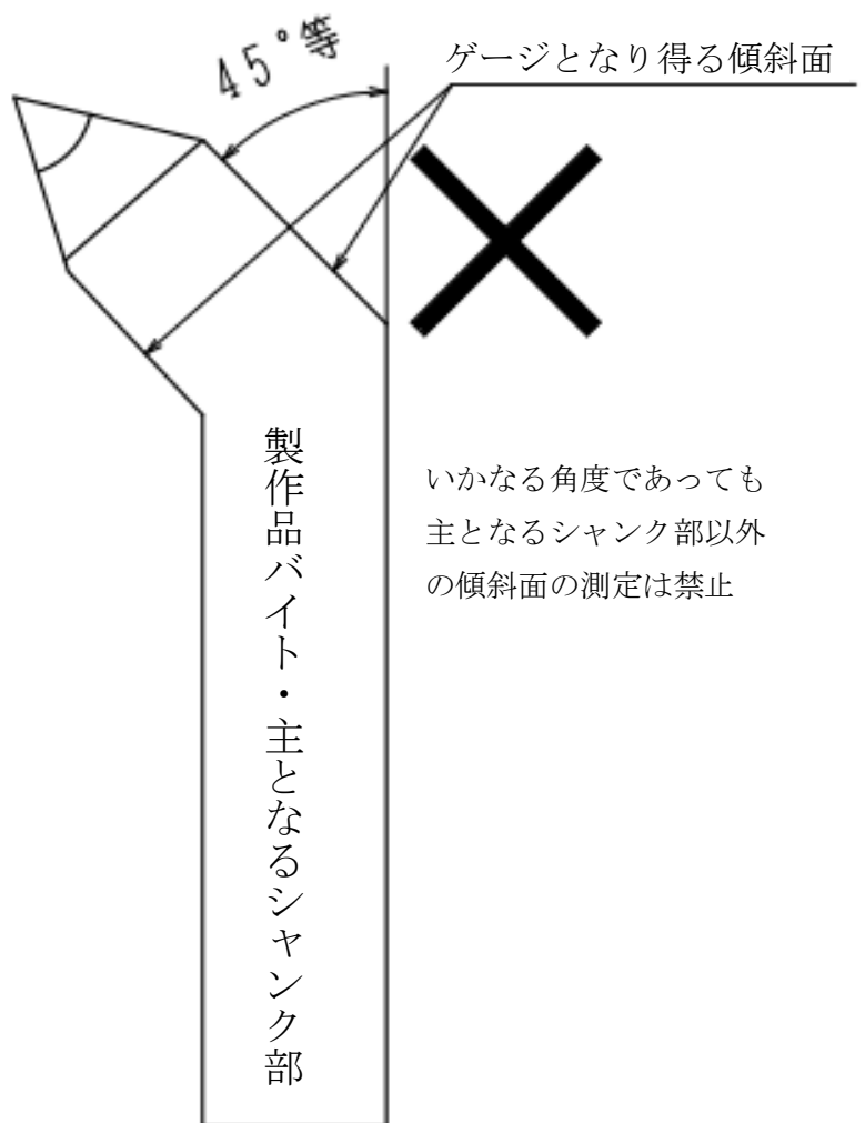
図10 課題テーパ角近似傾斜面の製作の禁止
