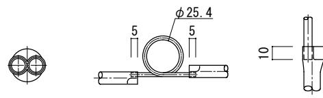
太い配管が細い配管を包み込むように加工し、口ウ付ける
