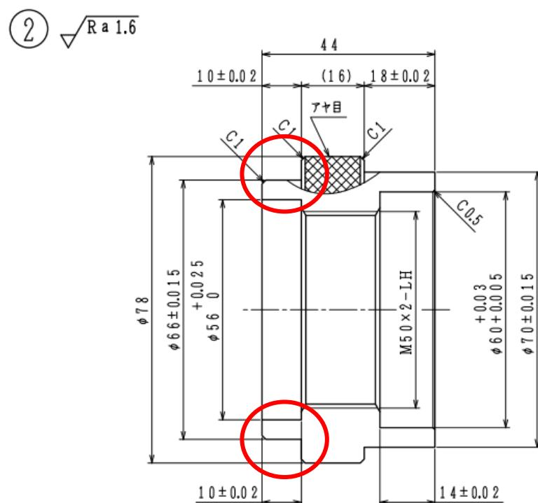
部品②の部品図だけでなく、組立図A、Bの部品②の同一箇所もずれているため、組立図A、組立図Bも同様に修正します。
