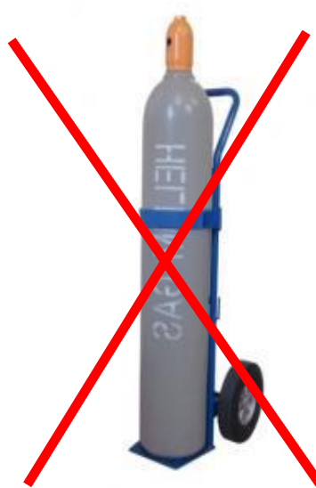
細身の1本運搬台車を使用して直立させて使用したもの
