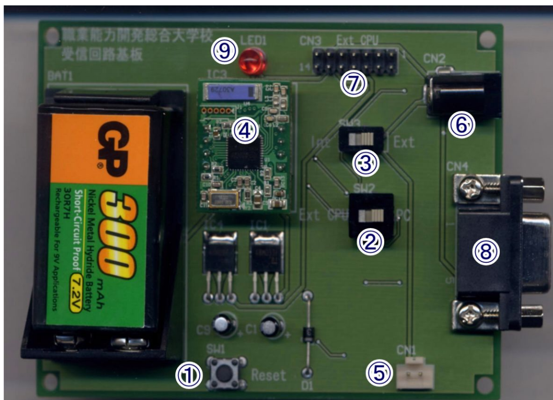
図 2 ZigBee モジュール設定基板の外観図
